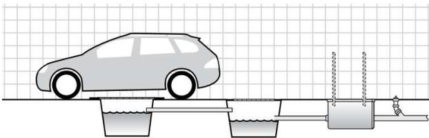
La Régie précise qu'un séparateur d'huile est exigé dans un atelier d'entretien mécanique, un garage ou tout endroit où un moteur à explosion est réparé, lubrifié, entretenu ou lavé. Il en est de même pour les systèmes de freins, de transmission ou d'essence d'un véhicule.
