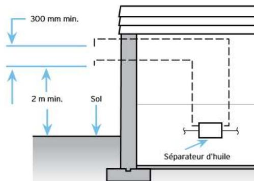
Les 2 tuyaux de ventilation d'un séparateur d'huile doivent être raccordés à ses extrémités.
